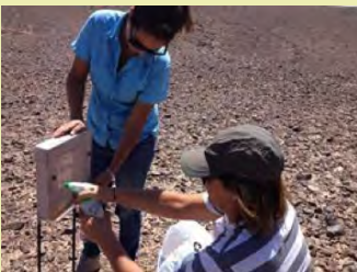
Foto 11: Instalación y seguimiento de los monitores de partículas.
