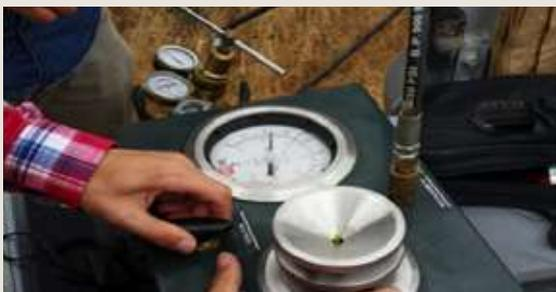
Foto 4: Medición del potencial hídrico xilemático mediante bomba Scholander en viña San Diego.
