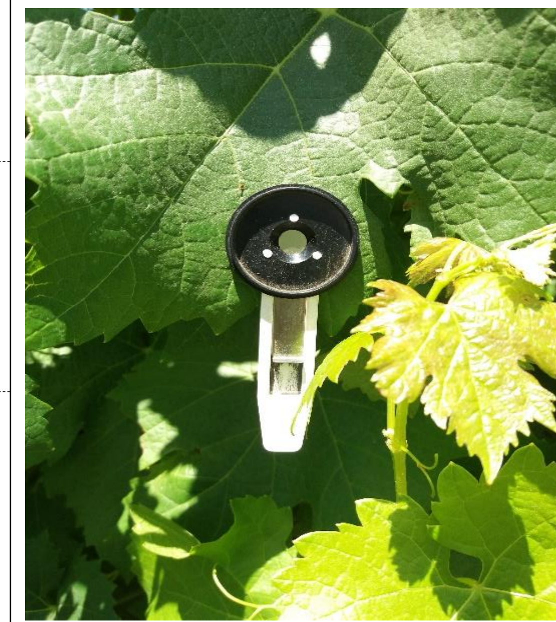
Figura 6. Acondicionamiento hoja para medición de fluorescencia
